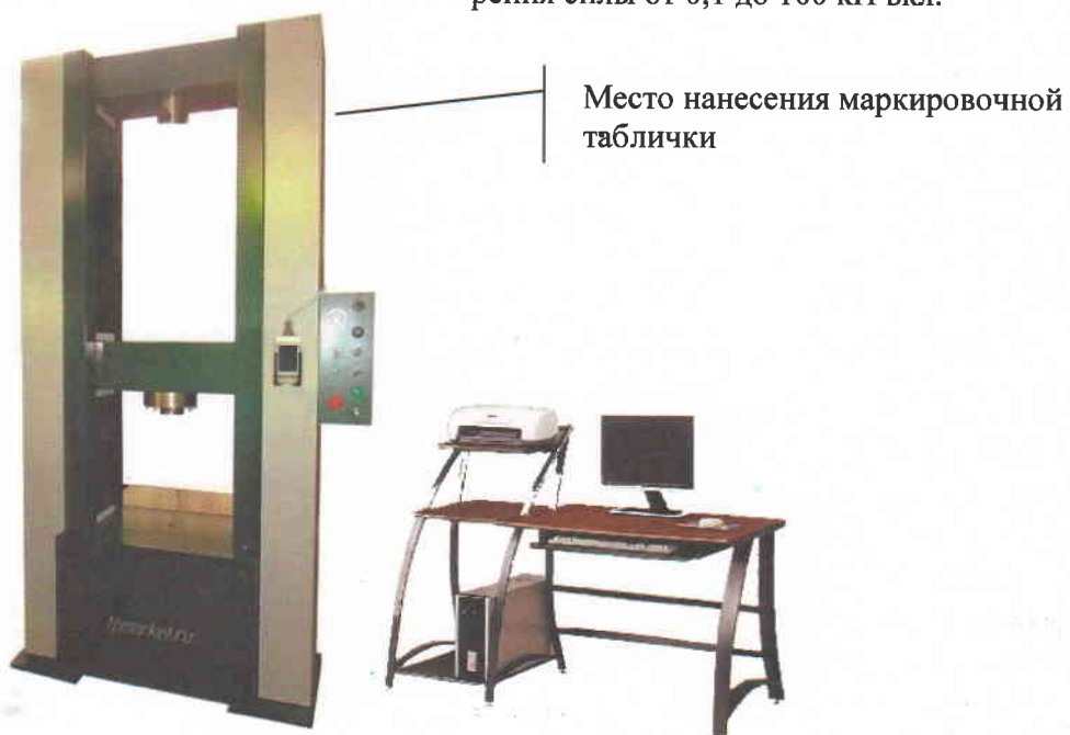
Рисунок 5 - Общий вид машин модификации IP 52Y-PS с верхним пределом диапазона измерения силы от 200 до 600 кН вкл.
